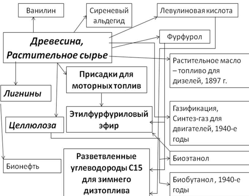
Схема 1. Продукты переработки древесины и растительного сырья в биотоплива и малотоннажные продукты
