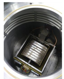
Импульсный трансформатор модулятора
