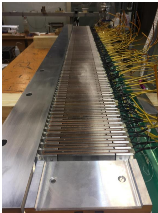
Нижняя половина полюса СП ондулятора с периодом 15.6 мм
