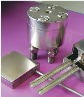
Микрореакторы для каталитических процессов
