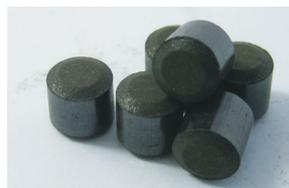
Катализатор низкотемпературной конверсии оксида углерода в производстве аммиака
