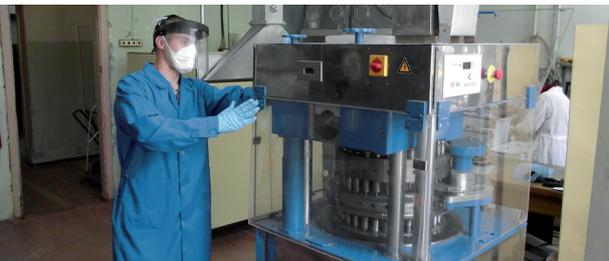
■ Экструдер для формовки катализаторов и носителей
