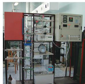
■ Установка для испытания катализаторов в процессах нефтепереработки
