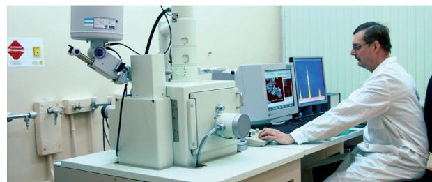
■ Исследование поверхности твёрдых тел на растровом электронном микроскопе
