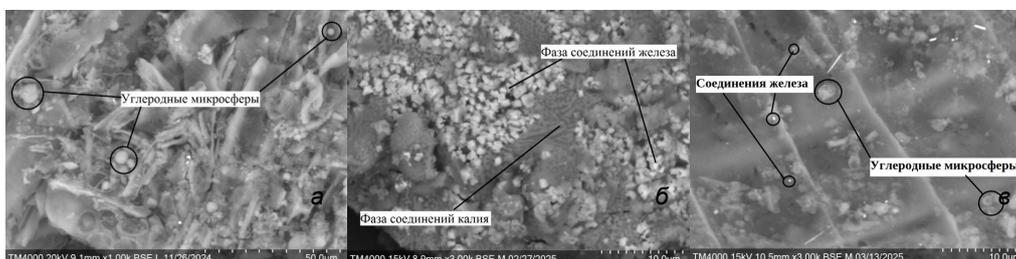
Рис. 1. Поверхность образца исходного гидроугля НС-230 (а); после пропитки  $K_3[Fe(CN)_6]$  с последующей карбонизацией при 800 °С (б); после отмывки карбонизованного образца HCl (в).
