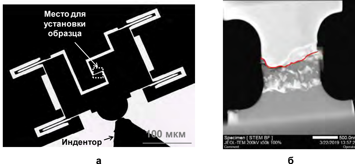
Рисунок 1. ПЭМ-изображения устройства «Push-to-pull» (а) и STEM-изображение ламели, предназначенной для in situ испытаний на растяжение (б)
