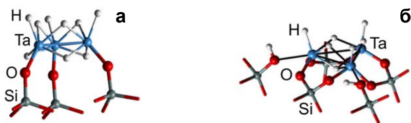
Рис. 1. Наиболее стабильные кластеры Ta_3H_9 и Ta_3H_7 , закрепленные на вицинальных \equiv Si(OH) (а) и геминальных =Si(-OH)_2 (б) поверхностных силанольных группах \beta -кристаллита
