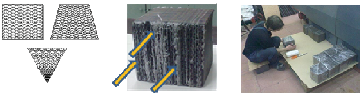
Рис.1. Структурированные каталитические картриджи со стекловолокнистым катализатором.
