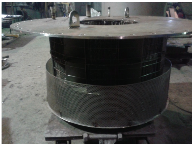
Рис.2. Радиальный слой катализатора из призматических картриджей.
