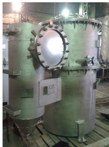
Рис.3. Каталитическая система для очистки и охлаждения выхлопов стационарных дизель-генераторов
