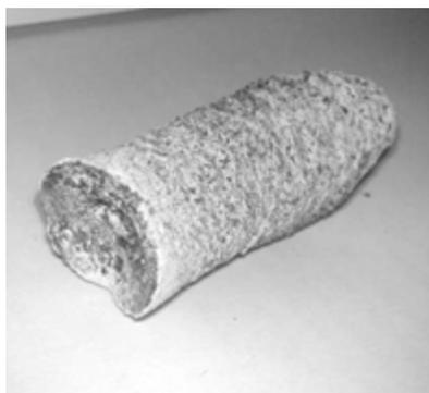
Рис. 1. Внешний вид образца  $\text{ZrO}_2 + \text{ZrB}_2$  после синтеза
